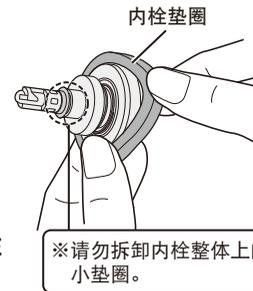
※ 请勿拆卸内栓整体上的小垫圈。
