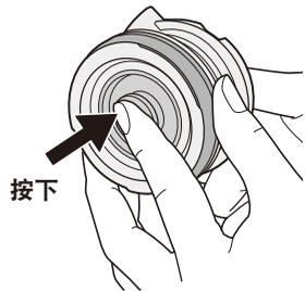
② 紧紧抓住弹簧压杆，一边按压一边朝箭头方向旋转90度，取下弹簧压杆和弹簧。
